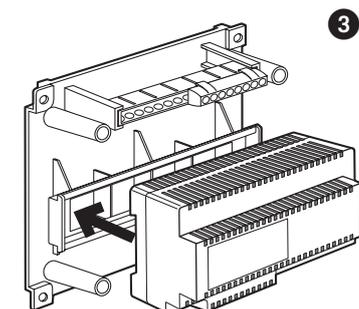
Installare l'alimentatore all'interno del centralino art. F115/8A (BTicino).
