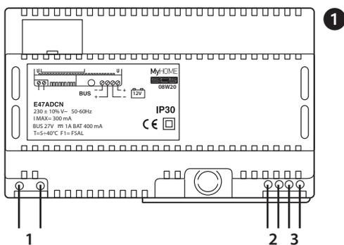
Collegare i cavi di alimentazione 230V a.c. ai morsetti (1) ed il BUS ai morsetti (2).
