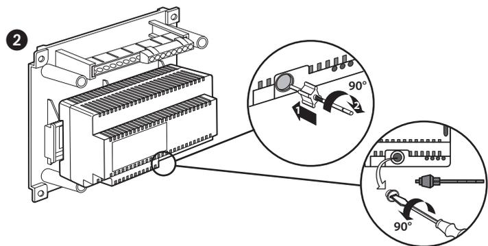
Estrarre completamente il dispositivo di protezione.
