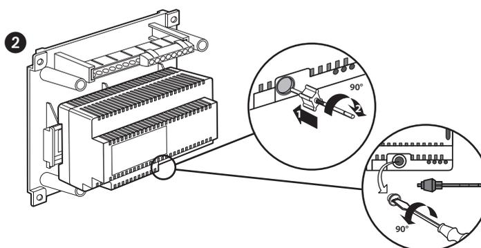
Extrair completamente o dispositivo de protecção.
