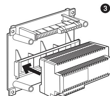
Das Netzgerät in die Zentrale Art. F115/8A (BTicino) installieren.
