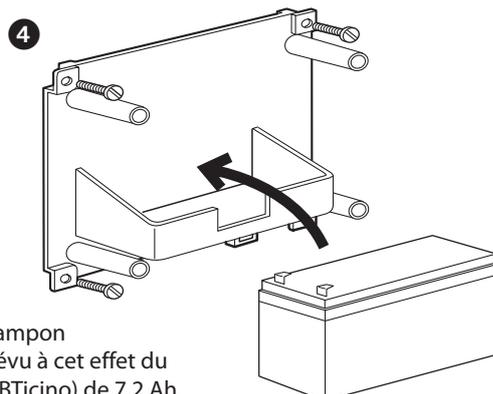
Installer la batterie tampon dans le logement prévu à cet effet du boîtier art. F115/8B (BTicino) de 7,2 Ah.
