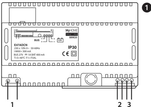
Conecte los cables de alimentación 230V a.c. a los bornes (1) y el cable telefónico a los bornes (2).
