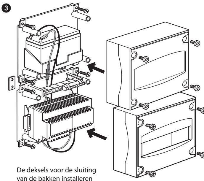
De deksels voor de sluiting van de bakken installeren
