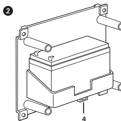
Caso se pretender proteger o vão da bateria, conectar o contacto existente na caixa art. F115/8B (BTicino) (4) com uma linha tamper.
