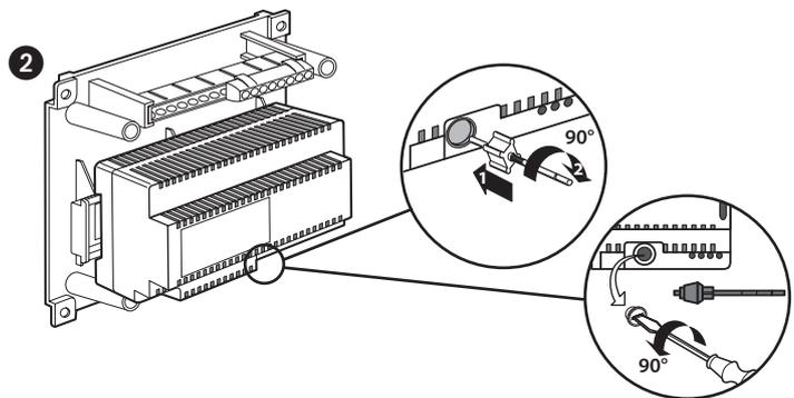
Extraiga completamente el dispositivo de protección.
