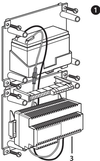
Collegare le batterie ai morsetti dell'alimentatore (3) utilizzando l'apposito cavo completo di protezione con fusibile.
