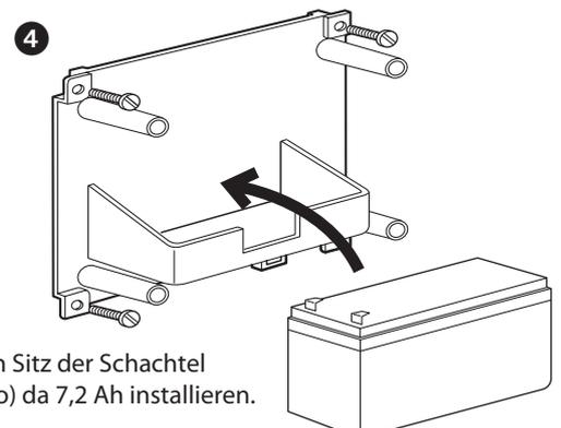
Pufferbatterie in den Sitz der Schachtel Art. F115/8B (BTicino) da 7,2 Ah installieren.
