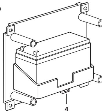
Si desea proteger el compartimiento de la batería, conecte el contacto presente en la caja Art. F115/8B (BTicino) (4) a una línea anti-intrusión.
