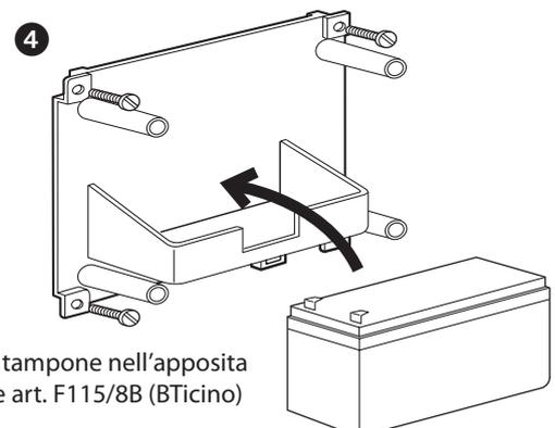
Installare la batteria tampone nell'apposita sede del contenitore art. F115/8B (BTicino) da 7,2 Ah.
