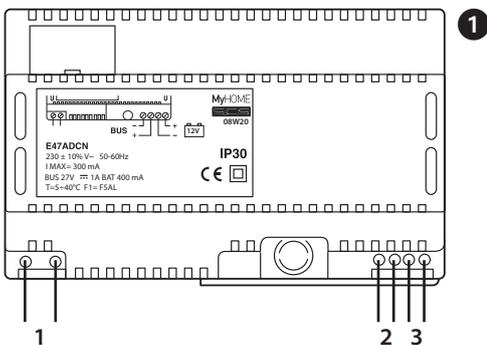
Die Speisekabel 230 V a.c. an die Klemmen (1) und die Telefonschleife an die Klemmen (2) schließen.
