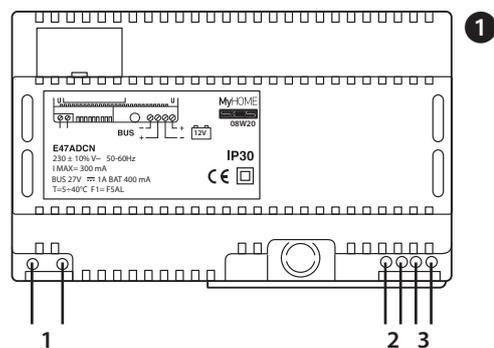
Brancher les câbles d'alimentation 230Vca aux bornes (1) et le câble pair téléphonique aux bornes (2).
