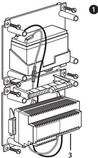
Die Batterie an die Klemmen des Netzgeräts (3) durch das entsprechende Kabel mit Sicherung schließen.
