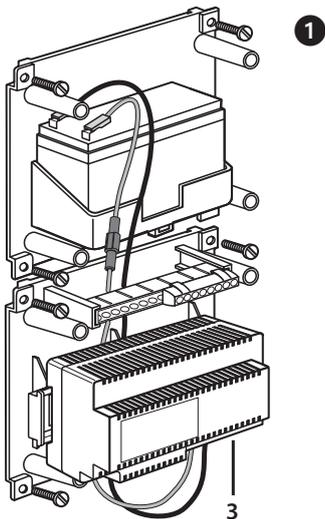
Conectar as baterias com os bornes do alimentador (3) utilizando o cabo de protecção apropriado com fusível.
