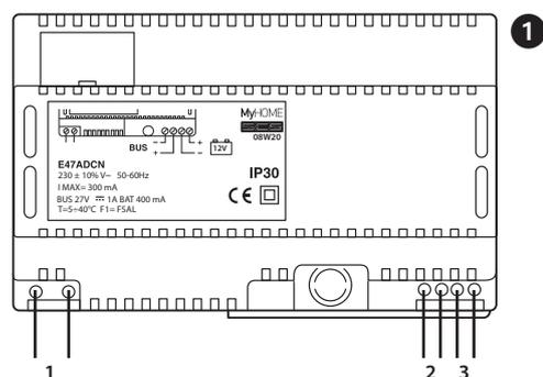
Conectar os cabos de alimentação 230V c.a. com os bornes e o par telefónico com os bornes (2).
