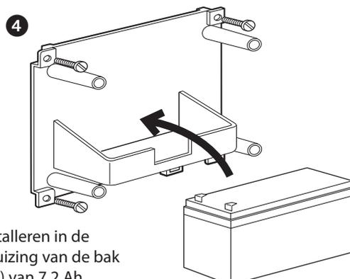
De bufferbatterij installeren in de desbetreffende behuizing van de bak art. F115/8B (BTicino) van 7,2 Ah.
