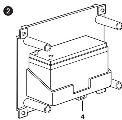
Falls der Batteriesitz geschützt werden soll, den Kontakt an der Schachtel Art. F115/8B (BTicino) (4) an eine Tamper-Linie schließen.
