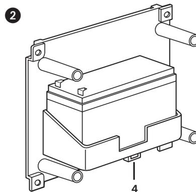
Ingeval men de batterijruimte wenst te beschermen, het contact dat aanwezig is op de bak art. F115/8B (BTicino) (4) verbinden met een tamperlijn.
