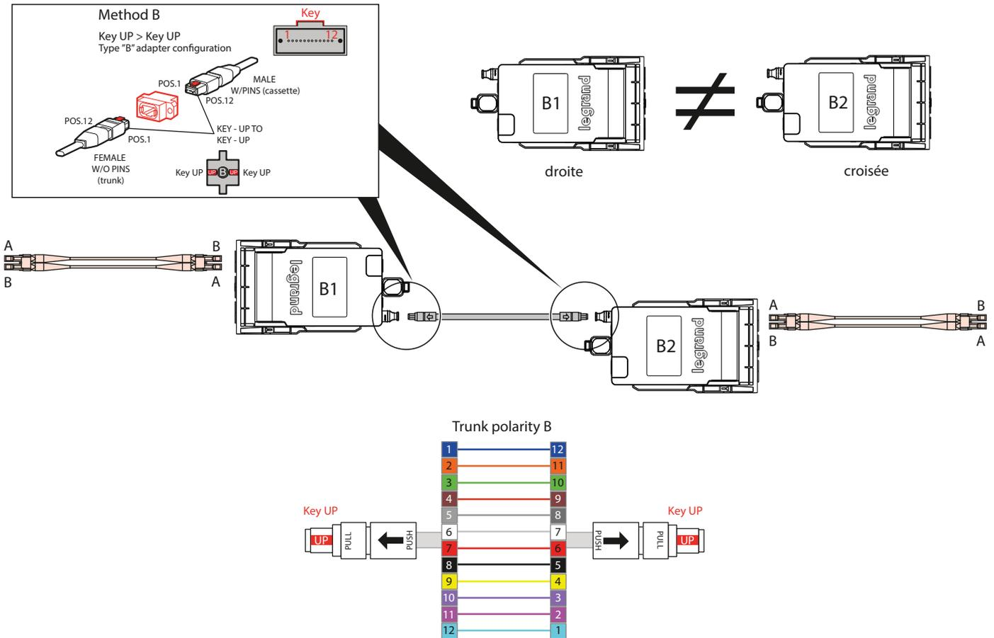
Pour les cassettes monomode en polarité B (traversée en « key-up/key-up »), le connecteur MTP mâle de la cassettes est « up-angled » selon l'IEC 61754-1-12 et donc seulement compatible avec des trunks MTP (ou MPO) femelle polarité B standards (« down-angled »). Trunks polarité B disponibles à la demande.
