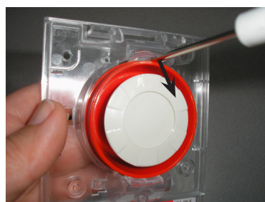
Déclipser le buzzer
