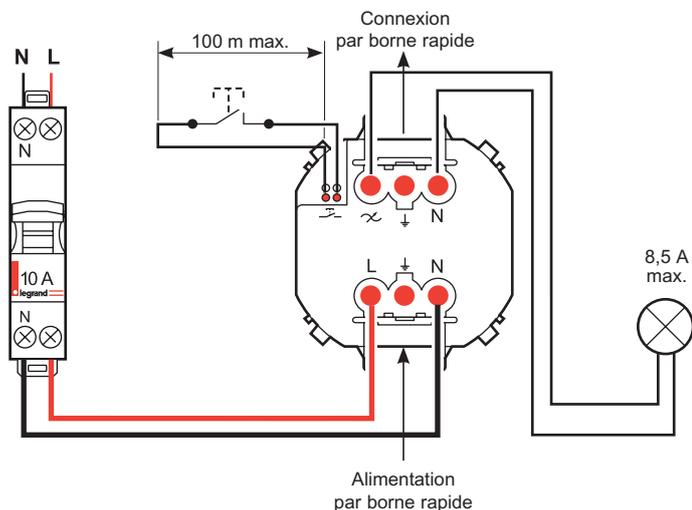
Un appui sur la commande auxiliaire permet d'allumer ou d'éteindre manuellement la charge. Si aucune action n'est effectuée sur la commande, le détecteur coupera sa charge en fin de temporisation ou lorsque le seuil de luminosité sera atteint.
