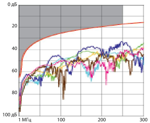
Неравномерность задержки распространения сигнала
