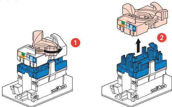
Данная система позволяет распределять пары перед установкой их на разъем.
