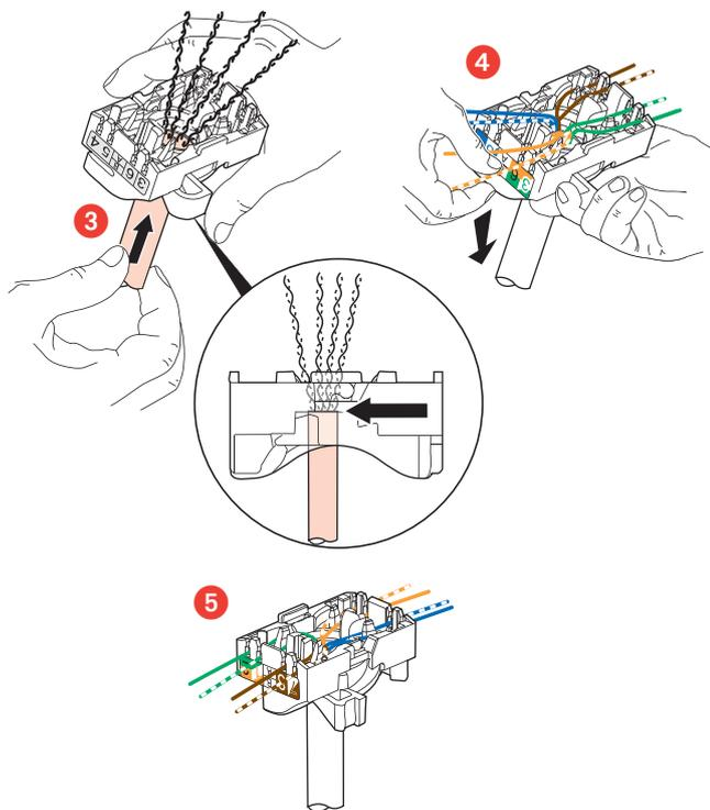
Распределение кабелей обеспечивает расстояние обрыва между каждой парой в 13 мм.
