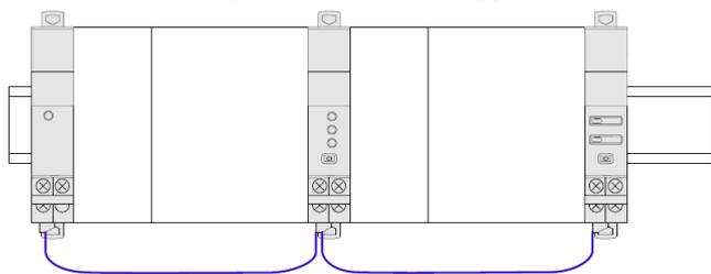
**Mise en œuvre :** avec cette façon de câbler, le cache plastique présent à l'arrière de tous les modules EMS CX<sup>3</sup> ne doit pas être enlevé.
