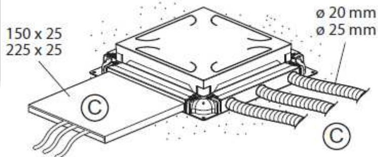
1- Raccorder les goulottes de sol ou les conduits en utilisant un outil pour l'ouverture de l'opercule
