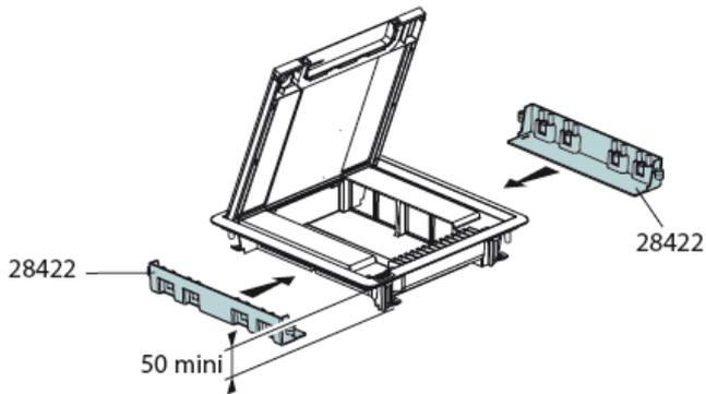
La hauteur minimum pour installer une boîte de sol à hauteur réduite doit être de 50mm.
