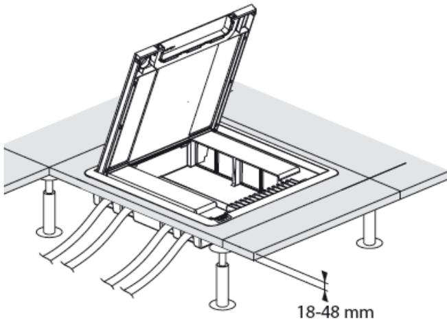
La hauteur minimum pour installer une boîte de sol à hauteur réduite doit être de 50mm.
