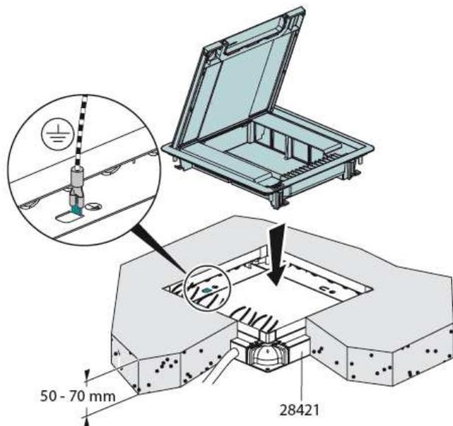
La hauteur minimum pour installer une boîte de sol à hauteur réduite doit être de 50mm (maxi 70mm)
