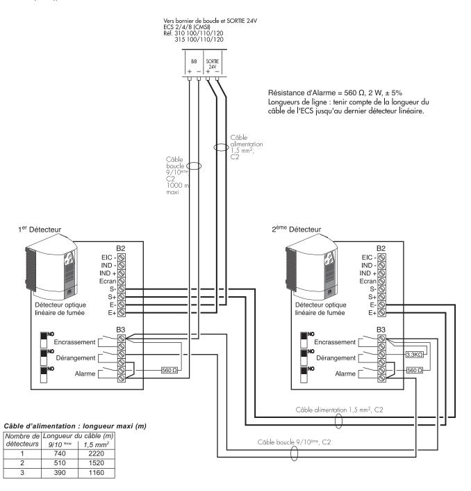
La sortie 24 V des ECS 2/4/8 (CMSI) ne peut alimenter que 3 détecteurs linéaires maximum. Pour en raccorder plus de 3, alimenter les détecteurs linéaires supplémentaires par une A.E.S. 24 V et utiliser la carte interface alimentation externe (voir paragraphe suivant).
