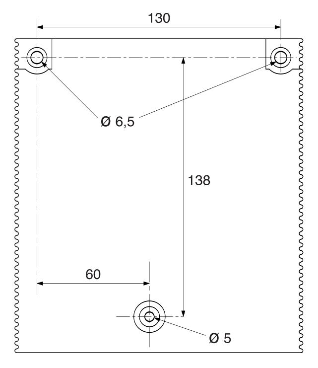
NOTA: les diamètres inscrits sur ce gabarit sont les diamètres maximum de perçage.
