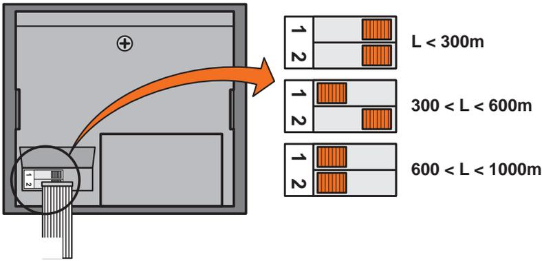
**I** L = distanza tra la telecamera e il posto interno più lontano (in impianti senza derivatore di montante art. 346100). Distanza tra la telecamera ed il primo derivatore di montante art. 346100.
