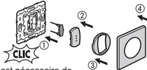
Il est nécessaire de disposer d'un fil de neutre sur l'interrupteur
